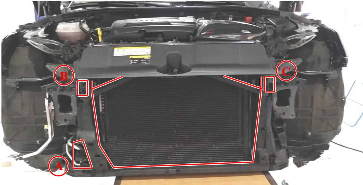
Entlang den rot gekennzeichneten Linien ca. 10-15mm Material entfernen. Bitte darauf achten, die dahinter sitzenden Versteifungsstreben auch entsprechend zu entfernen! Benutzen Sie dafür einen Dremel, Karoseriesäge oder ähnliches.
