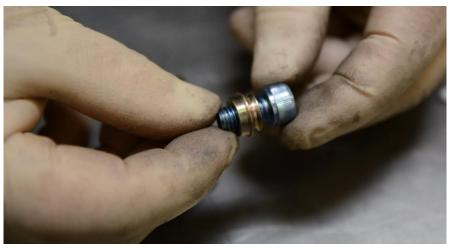
**Step 8**Apply blue Loctite to Allen bolt.
